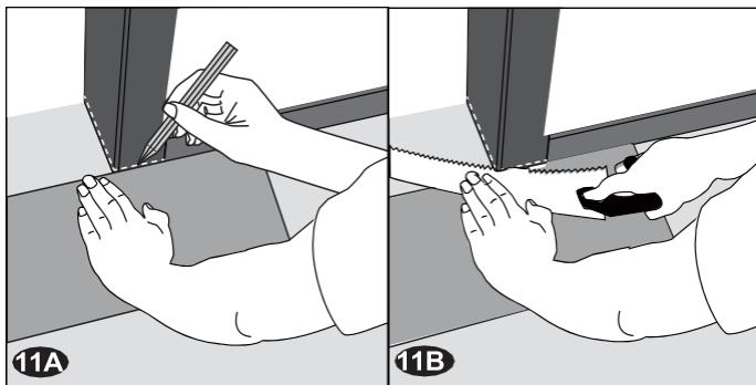
⑪ Molduras y faldas de puertas: Si una tabla debe caber debajo de una moldura o zócalo de puerta, coloque un trozo de tablón junto a la moldura o zócalo de la puerta y dibuje una línea contra la moldura o zócalo para establecer la altura de corte (11A). Con la tabla de desecho todavía en su lugar como guía, use una sierra de mano o equivalente para cortar la moldura o el rodapié (11B). Luego, deslice la nueva tabla debajo de la moldura.
