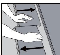
Separé toda la fila levantándola con delicadeza en un ángulo. Para separar las juntas finales de los tablones, déjelos planos en el suelo y deslícelos para separarlos. Si los tablones no se separan fácilmente, los puede levantar ligeramente en un ángulo (5°) al deslizarlos.
