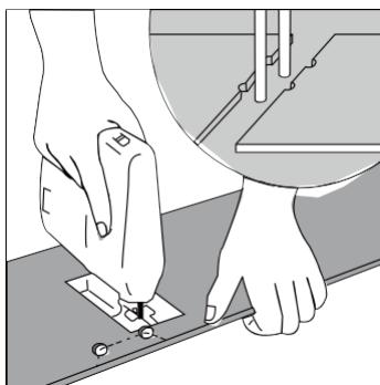
⑩ Agujeros para tuberías: medir el diámetro de la tubería y perforar un agujero de 1/2" (12mm) de más. Serruche un pedazo, como se muestra en la figura y ponga la placa en su sitio. Luego, coloque la pieza recortada en su lugar.
